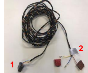
Mazo de cables MSDL A 0035406505
